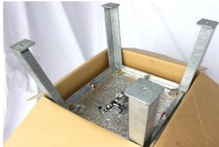
黄印ボルトに取付けた部品の、締め付けナットを、モンキーレンチやスパナで、強固に締め付けて下さい。
