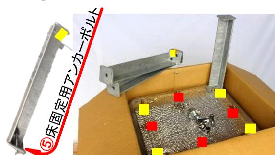
底板の黄印のボルトを、脚の黄印孔に挿し入れて、平座金・ばね座金の順に通し置いて、ナット締めして下さい。脚の無印孔と本体底板の無印孔は、**たंकん**を起こしてから、ボルトナットで締め付けるので、孔がずれないように、ご注意ください。
